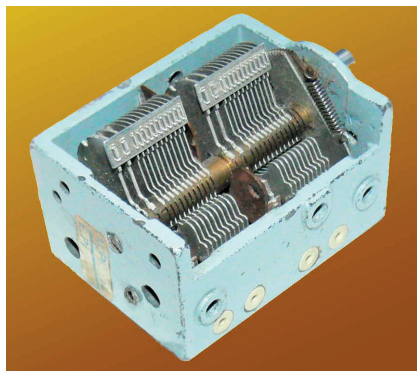
Obr. 1. Přijímačový ladící kondenzátor použitý v MLA
